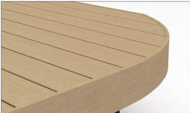
床板をアール形状に切断することで、きれいな曲線のデッキに施工することもできます。(R800以上、幕板Bタイプのみ)
