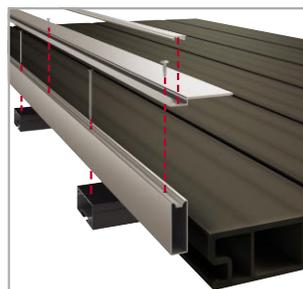
大引に幅調整材を固定し、カバーを取り付けて施工します。
