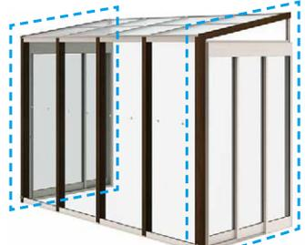
(注2) ガーデンルームタイプは、テラスBタイプの本体フレーム(屋根部セット+正面フレームセット)に、正面デザインパネル6型・8型と側面開口部を組合せたものになります。側面開口部のガラスは別売、または現地手配となります。
