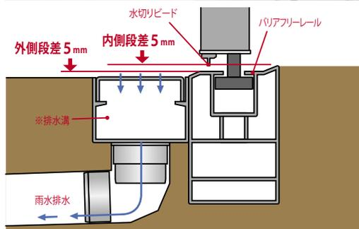
室内側・室外側のレールの水切り勾配をそれぞれ最小限の5mmに設計。折りたたみ戸の下部に水切りビードを装備し、レール内部、ガーデンルーム内に雨水の侵入を防止しました。(上図は土間仕様の場合)
