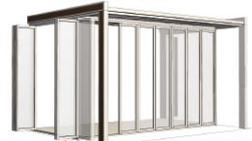
②前面の折りたたみ戸はコーナーで折りたたんで90°まわし、側面側へ移動します。
