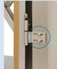
カバーを外し、六角ボルトをゆるめて、引手框の高さを調整します。
