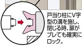
戸当り柱にV字型の溝を施し、閉じる時、扉がブレても確実にロック。
