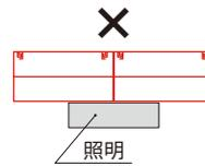
※照明は柱の120mm面に取付けてください(左図のように柱を連結した場合、連結部を跨いで照明を取付けないください)。
