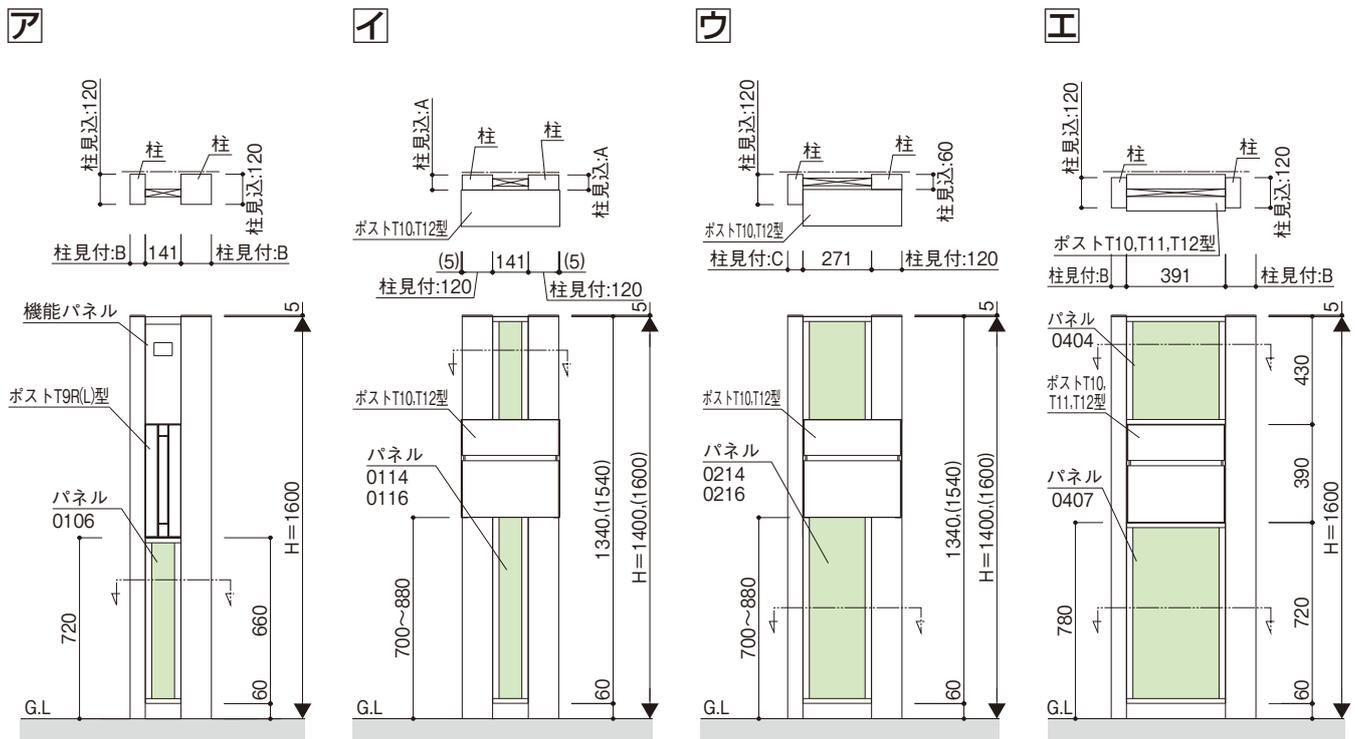
A寸法: 60, 120 / B寸法: 30, 60, 120 / C寸法: 30, 60 / 基礎幅W寸法: 350以上、かつ、本体幅+200
