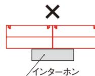
※インターホンは柱の120mm面に取付けてください(左図のように柱を連結した場合、連結部を跨いでインターホンを取付けないください)。
