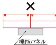
※機能パネルの見込には、柱の120mm面が取付くようにしてください(柱を連結した場合、連結部を跨いで機能パネルを取付けないでください)。
