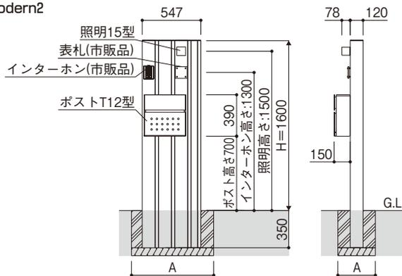
A寸法:350以上、かつ、柱外寸+200 寸法図:縮尺1/50(単位mm)
