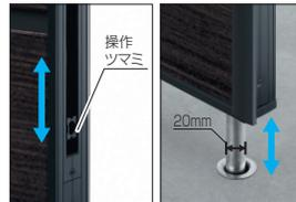
受側扉には大径の落し棒を採用し、扉のガタつきを抑えた仕様です。また、外部から落し棒を持ち上げることができないロック機能付きです(落し棒の操作は手動です)。
