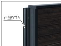
戸当りゴムの全長化、制振材の使用やラッチ受けに樹脂製減音ピースを内蔵、さらに丁番の軸受け部に樹脂を組み合わせ、扉開閉時における形材門扉特有の金属やラッチの衝撃音・共鳴音を低減させました。
