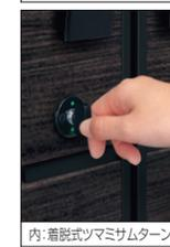
●家側は状況により使い分けができる仕様です(工場出荷時は、ツマミ式となっておりますが、現地でツマミ部を取りはずし、簡易錠(コイン式)としても使用できます)。また、施錠錠の状態を確認しやすい開閉マークを採用しています。
