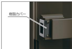
錠前ラッチ受け部に樹脂カバーを設け、ラッチ納まり時の接触音を低減しました(タッチ錠のみ)。
