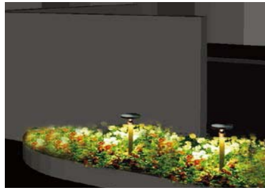
花壇やグランドカバーのエリアには、間接照明型の低ボール灯がお勧めです。花壇を明るくすると同時に、歩行のための路面の明るさも確保します。
