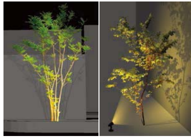
樹木のライトアップは、樹木手前のできるだけ幹に近い位置で、真上に向かって照射します。壁にシルエットを浮かびあがらせる手法もあります。
