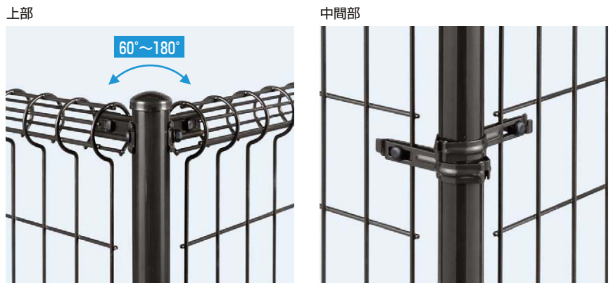
●角柱用部品(スチール) フェンス本体同士をコーナー部で連結する部品です。金具の取付け方により60°~180°に対応できます(写真は、90°以上180°未満の取付け方の場合です)。
